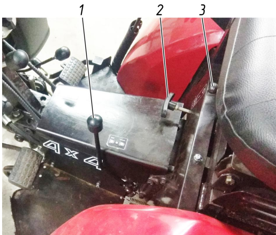
Рисунок 2.1.3 – Расположение органов управления мини-трактора 1 – рычаг переключения оборотов ВОМ. Имеет три положения: - переднее – ВОМ включен на частоту вращения 1200 \text{ мин}^{-1} при зависимом приводе или 7,028 \text{ об/м} пути при синхронном приводе; - заднее – ВОМ включен на частоту вращения 630 \text{ мин}^{-1} или 3,803 \text{ об/м} пути; - среднее положение – нейтральное. 2 – рукоятка управления блокировкой дифференциала заднего моста. 3 – рукоятка регулировки сиденья.
