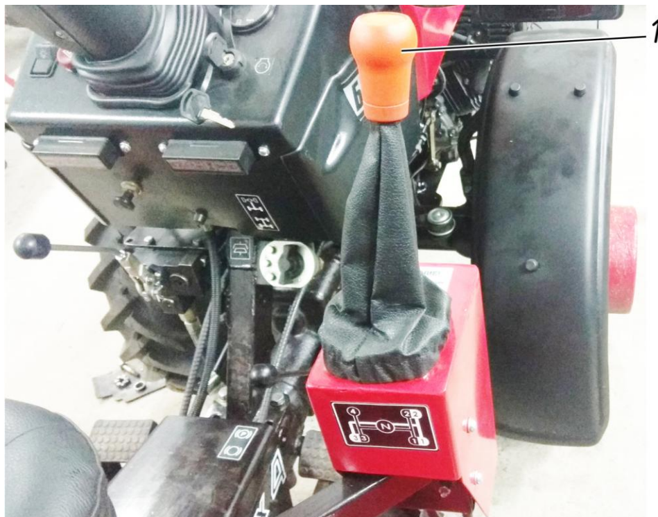
Рисунок 2.1.2 – Расположение органов управления мини-трактора 1 – рычаг переключения передач. Схема переключения передач показана на рисунке 2.5.
