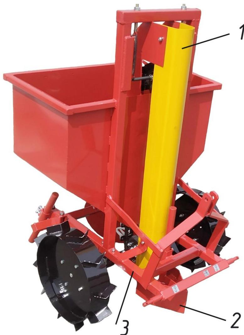
Рисунок 1 – Картофелесажалка КСН-1
